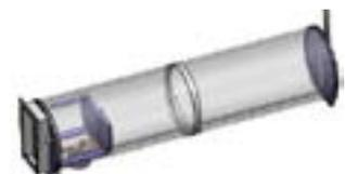
Der neue Hochbehälter misst eine Länge von 11,0m und hat einen Innendurchmesser von 2,5m!
